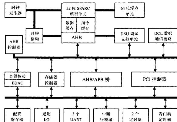
图 1 S698M 处理器结构图
